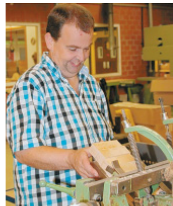
Am Drechselautomat: Andreas Koch demonstriert gerne, wie hier gearbeitet wird. An dieser Maschine werden Griffe für Feilen gedreht. FOTOS: SABINE HEINEMANN
